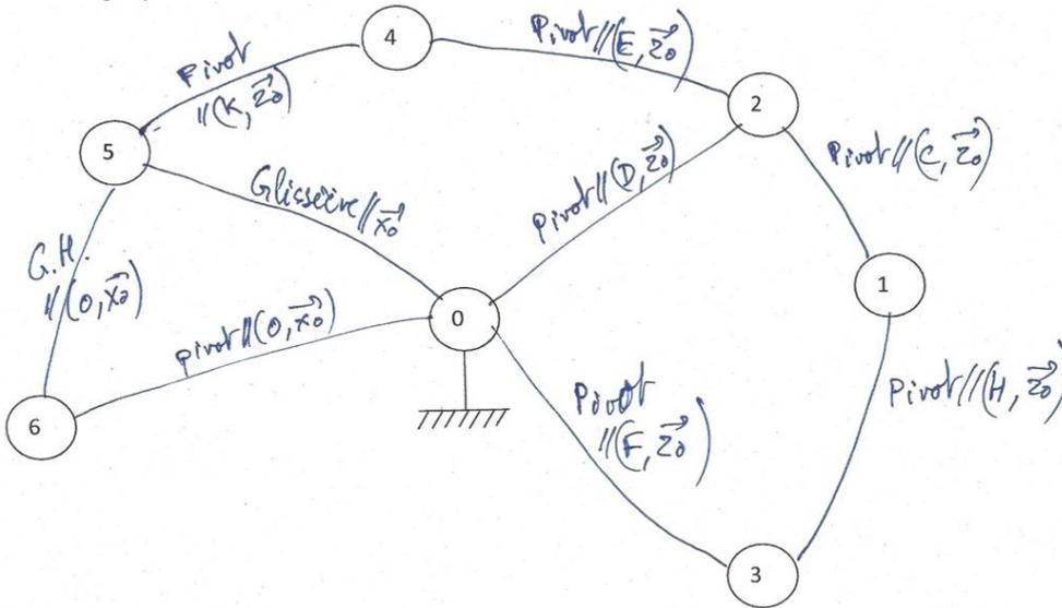
2. Définir les torseurs cinématiques suivants en donnant leurs éléments de réduction aux points de votre choix :  $\{V_{6/0}\}$ ,  $\{V_{5/0}\}$ ,  $\{V_{1/0}\}$ ,  $\{V_{3/0}\}$  et  $\{V_{2/0}\}$
