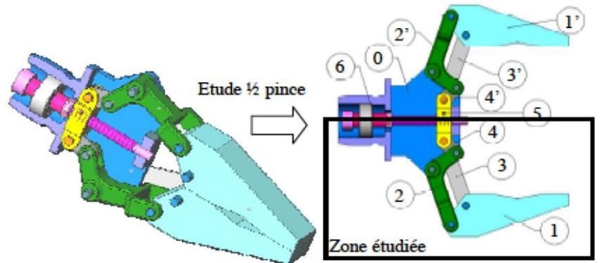
On comprend que lorsque le moteur tourne, la rotation de la vis (6) entraîne une translation de l'écrou (5) par rapport au carter (0). Ce mouvement est transmis par la bielle (4), il en résulte une rotation de l'équerre (2) autour du point D. Par construction,  $DC = FH = a$  et  $DF = CH = b$ . Ce qui impose que la rotation de la barre (3) est toujours identique à celle de l'équerre (2). Il en résulte que la direction  $\overline{CH}$  reste constante par rapport à (0) au cours du mouvement.
